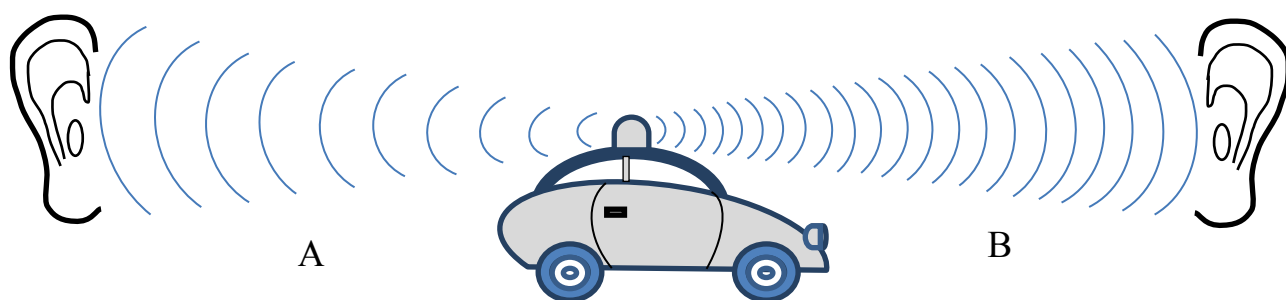
Рис. 21. Схема эффекта Доплера – изменения частоты звуковой волны при движении источника звука в направлении от (А) и к приемнику (В) звука.
