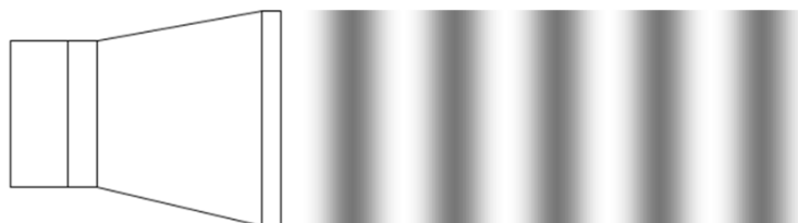
Рис. 15. Схема распространения звуковой (ультразвуковой) волны в среде при генерации ее источником.
