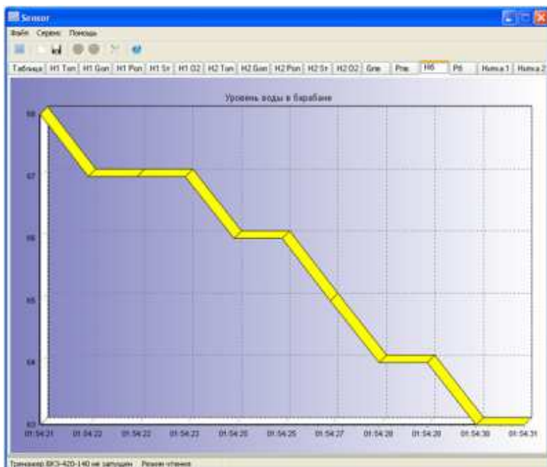
Рис. 19.4.4. Внешний вид пакета «Sensor», диаграмма уровня воды в барабане котла БКЗ-420-140
