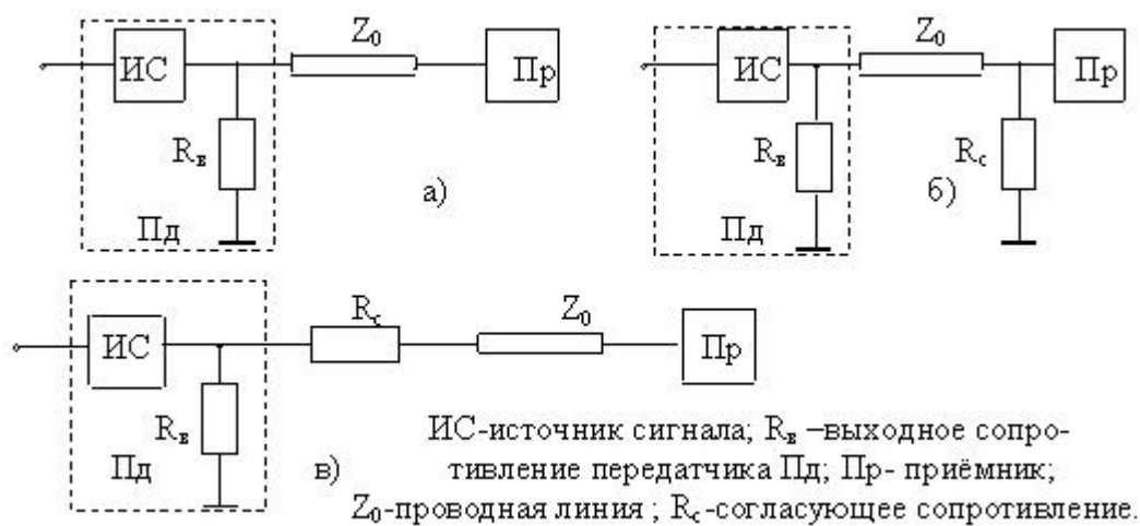
Рис. 4.9. Варианты согласования линий связи: (а) согласование отсутствует; (б) параллельное согласование; (в) последовательное согласование
