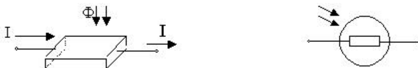
Рис. 12.3. Конструктивное представление и УГО фоторезистора
