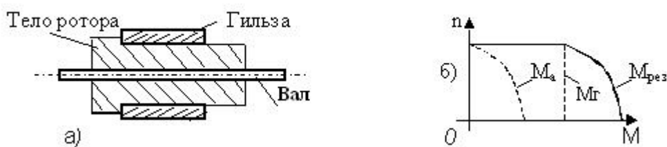
Рис. 6.10. Конструкция ротора (а) и механическая характеристика (б) гистерезисного микродвигателя
