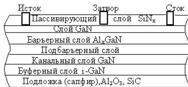
Рис. 10.22. Структура транзистора на гетеропереходах
