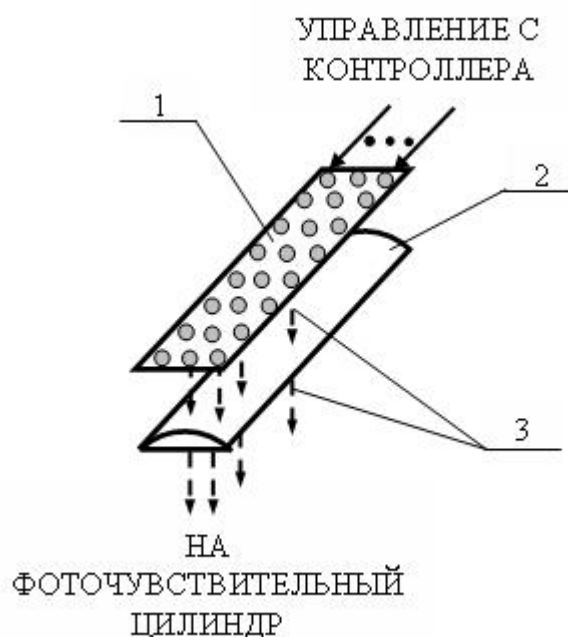
Рис. 25.40. Упрощенная типовая структура ОМБ при параллельном способе экспонирования: 1 – светодиодная матрица; 2 – фокусирующая линза; 3 – световые лучи
