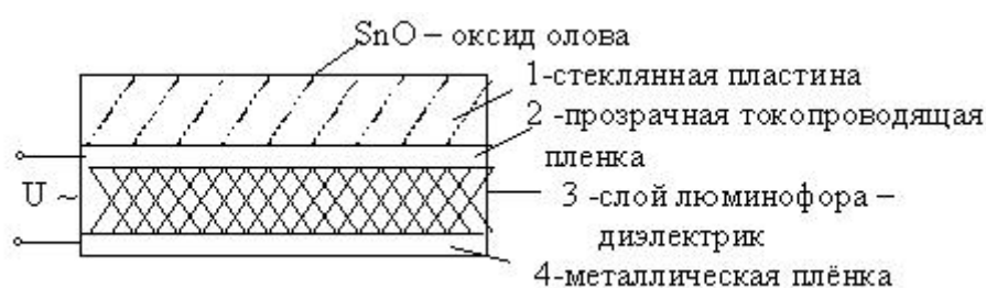
Рис. 13.2. Структура электролюминесцентного индикатора
