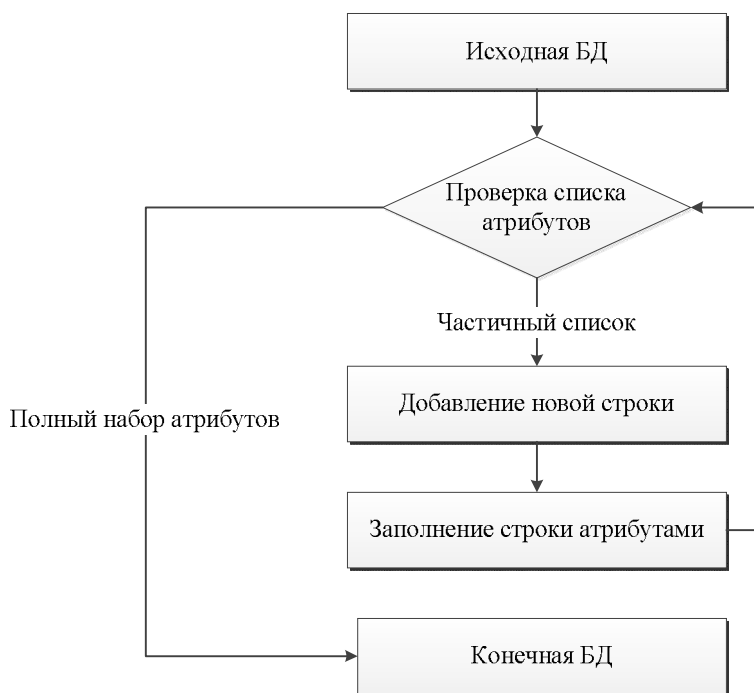
Рисунок 26. Блок-схема пополнения словаря
