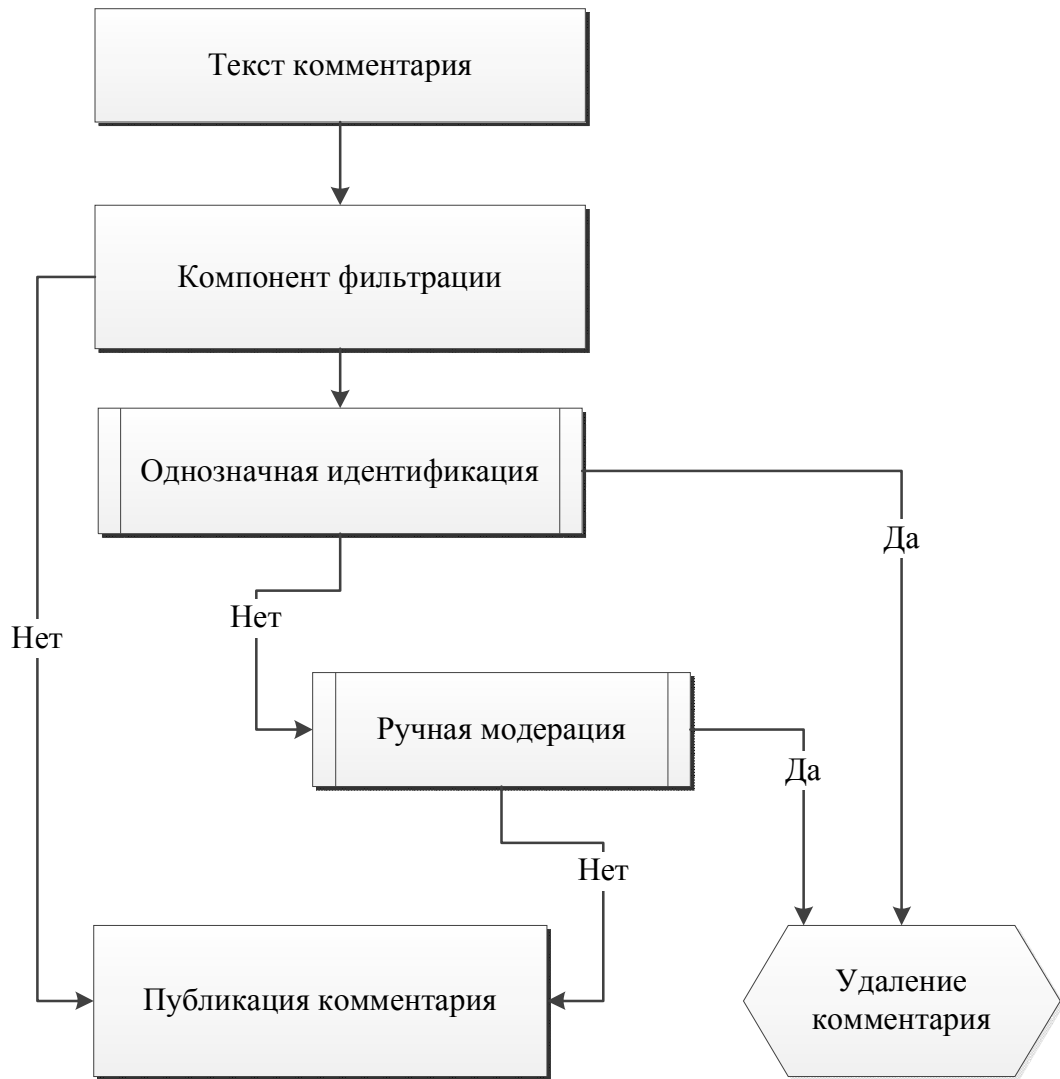
Рисунок 23. Упрощенная схема автоматизации АРМ модерирования
