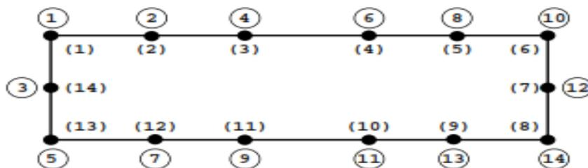
Рис.2.9.Альтернативные схемы нумерации узлов сетки.
