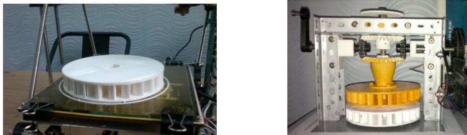
Рис.4.2. Представлен колес изготовлении с помощью 3-D принтера.
