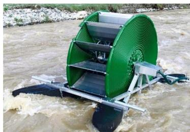
Рис.1.7. Погружной микроГЭС.
