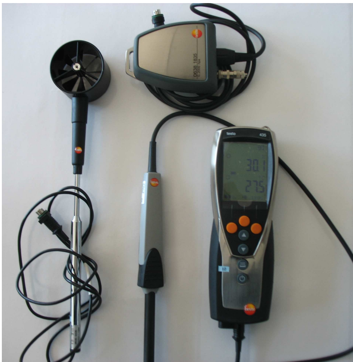
ИЗМЕРИТЕЛЬ С ВНЕШНИМИ НАСАДКАМИ Скорость движения воздуха – анемометр крыльчатый Давление – барометр 0638 1835 Температуру влажность - термогигрометр
