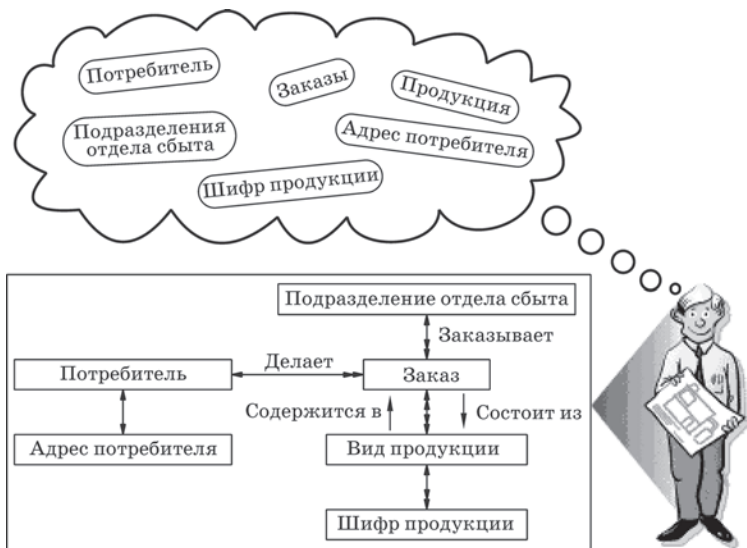
Рис. 2.13 Фрагмент предметной базы данных «Сбыт» и одно из возможных его концептуальных представлений
