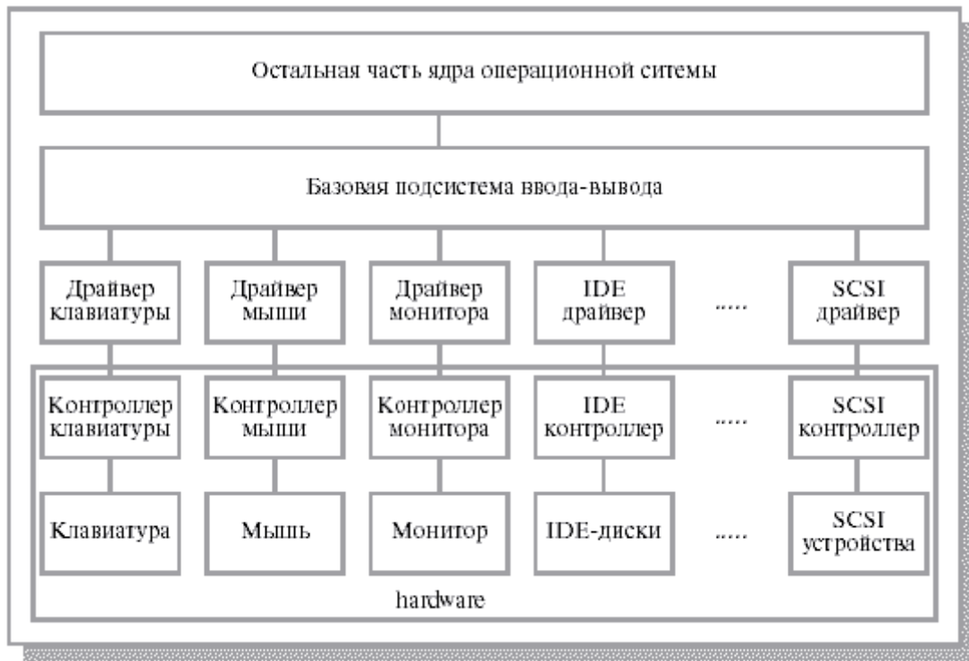
Рис. 13.1. Структура системы ввода-вывода
