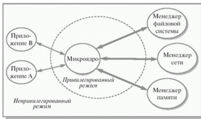
Рис. 1.4. Микроядерная архитектура операционной системы
