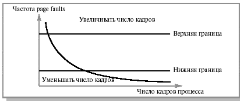
Рис. 10.3. Частота page faults в зависимости от количества кадров, выделенных процессу
