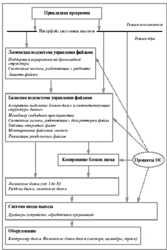
Рис. 12.1. Блок-схема файловой системы
