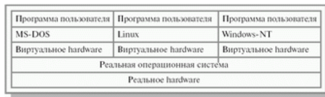
Рис. 1.3. Вариант виртуальной машины
