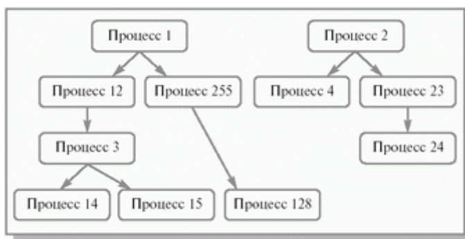
Рис. 2.4. Упрощенный генеалогический лес процессов. Стрелочка означает отношение родитель–ребенок
