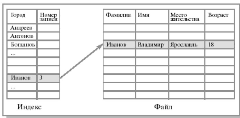
Рис. 11.2. Пример организации индекса для последовательного файла
