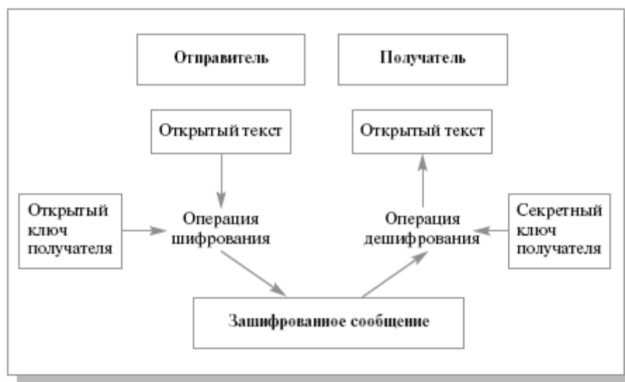
Рис. 15.1. Шифрование открытым ключом
