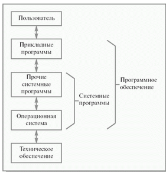
Рис. 1.1. Слои программного обеспечения компьютерной системы
