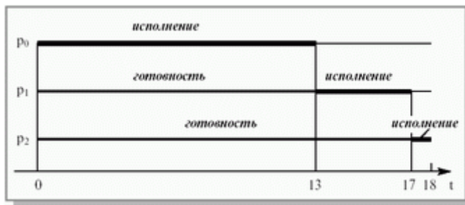
Рис. 3.2. Выполнение процессов при порядке p_0, p_1, p_2
