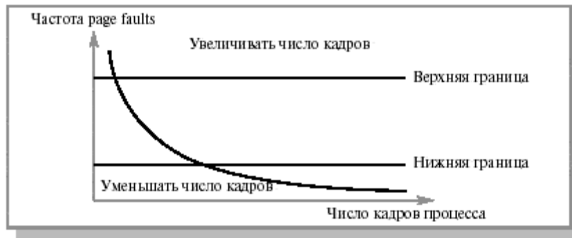
Рис. 5.3. Частота page faults в зависимости от количества кадров, выделенных процессу
