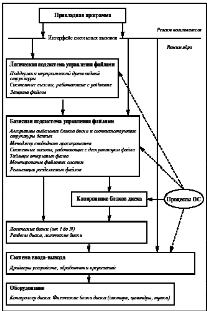
Рис. 6.5. Блок-схема файловой системы
