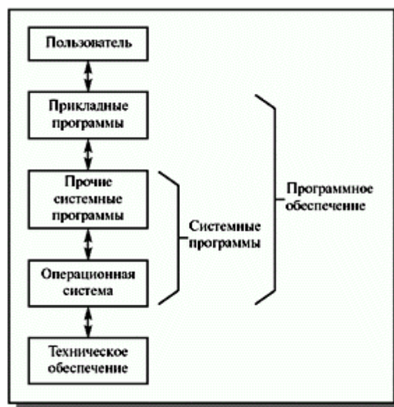
Рис. 1.1. Слои программного обеспечения компьютерной системы
