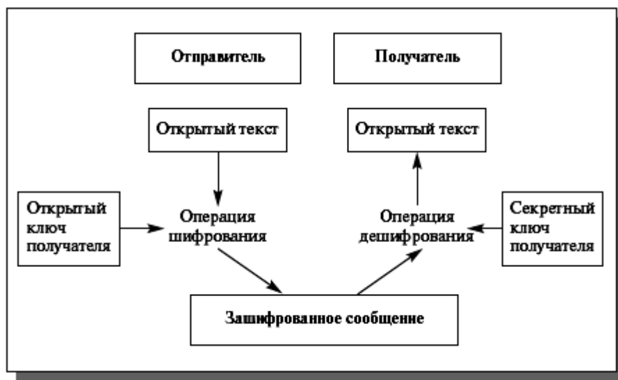
Рис. 9.1. Шифрование открытым ключом
