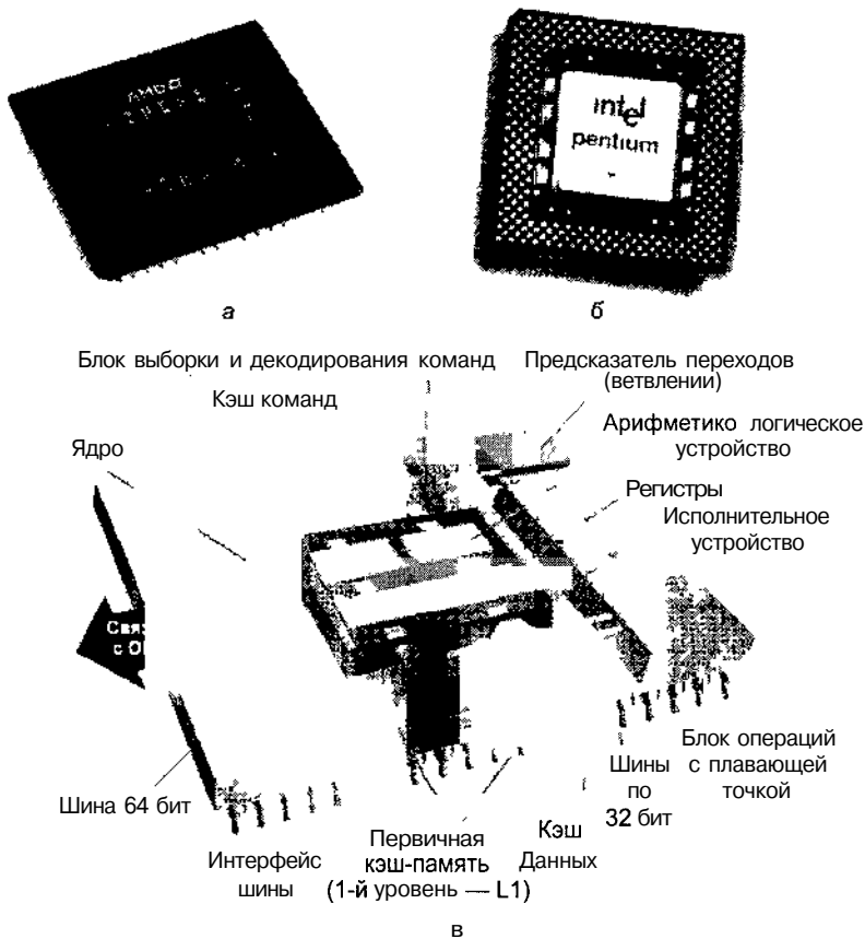
Рис 2 13. Микропроцессоры AMD (а), Intel Pentium MMX (б), основные компоненты процессора Pentium (в)
