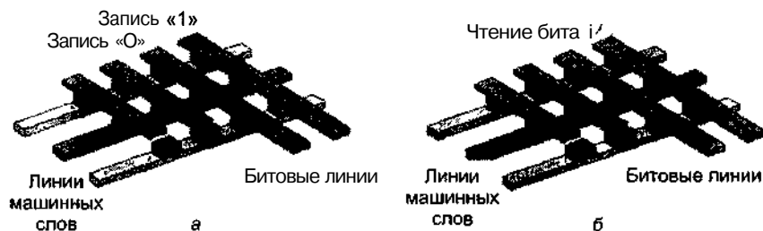
Рис. 2.20. Принцип функционирования MRAM а — запись данных, б — считывание
