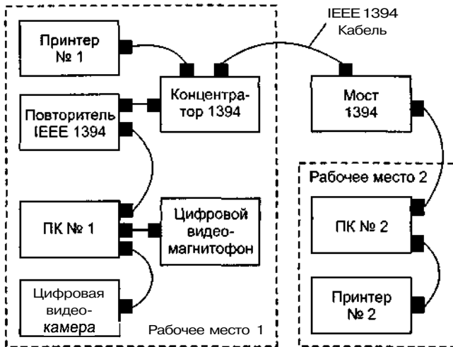
Рис. 2.34. Соединение разнотипных устройств в сеть с использованием IEEE 1394
