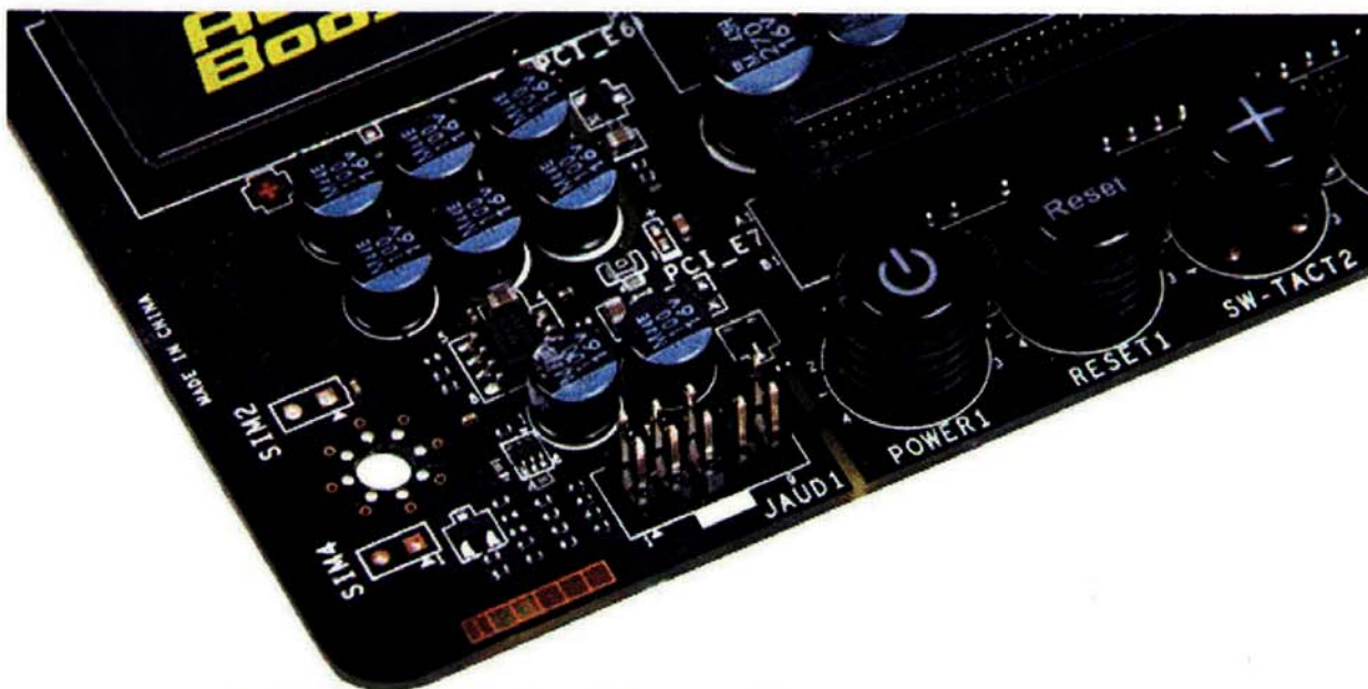
Внутренний разъем для микрофона и наушников
