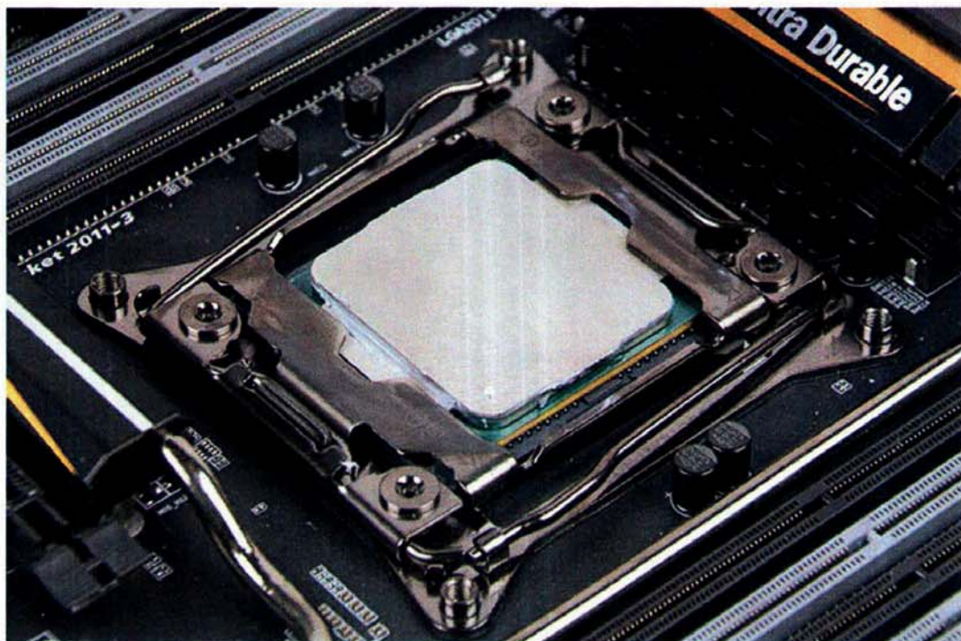
Посадочные отверстия для Intel LGA2011
