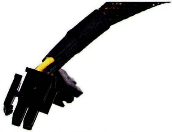
Кабель для питания центрального процессора
