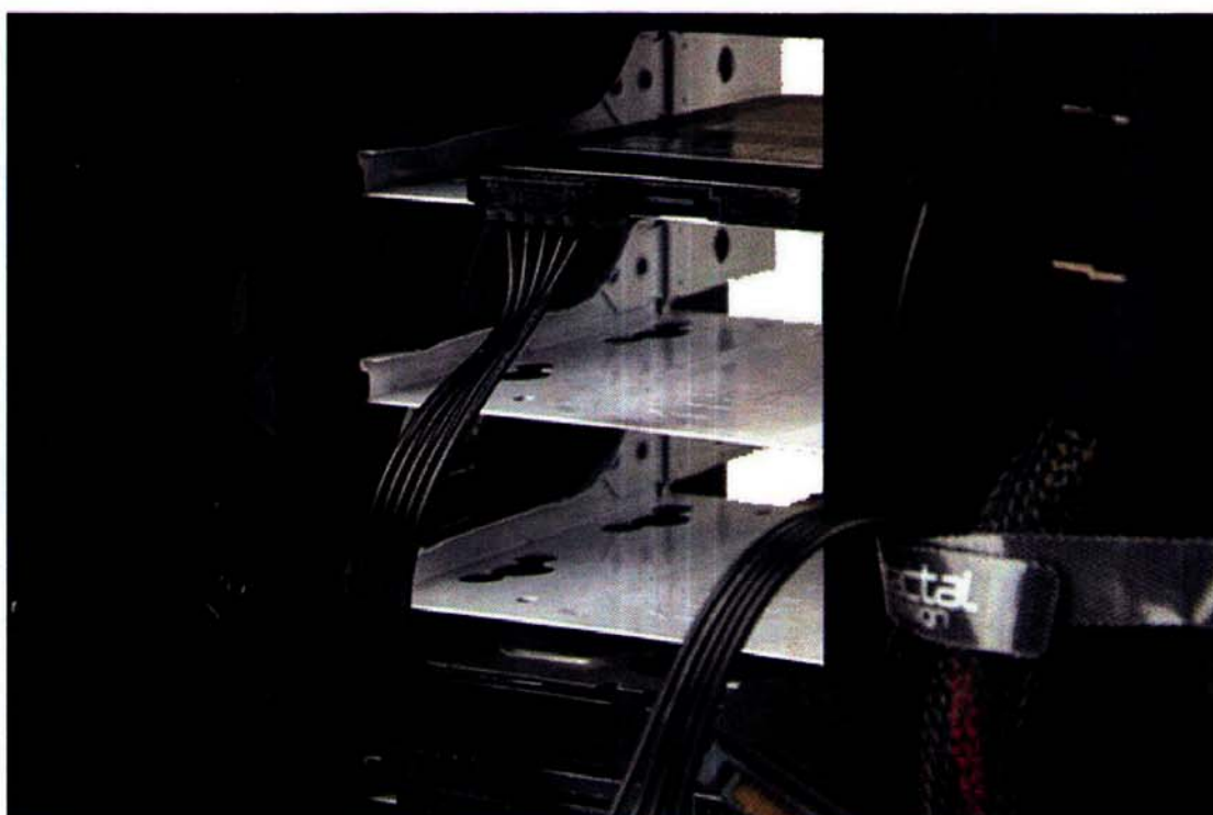
Подключение кабеля блока питания к накопителям
