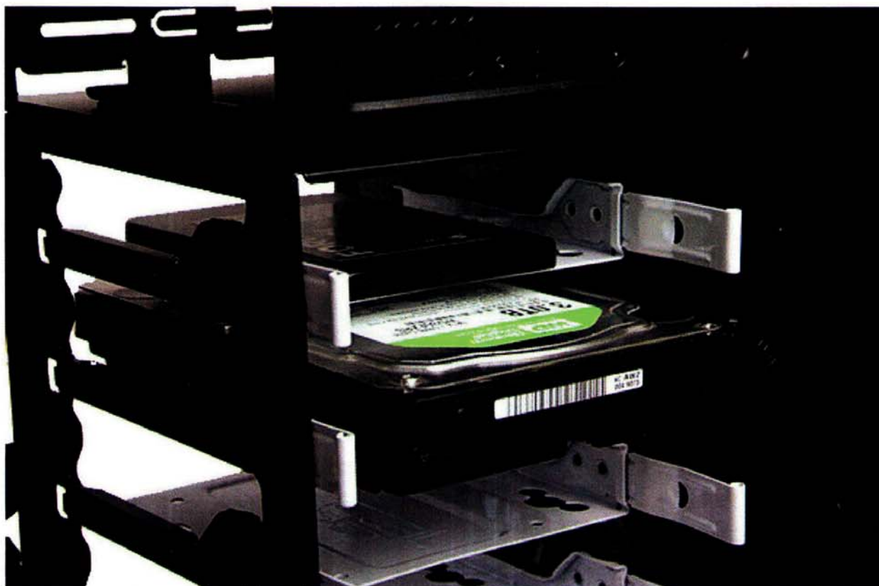
Установка салазок с накопителями в корзину корпуса
