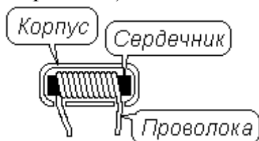
Рис. 2.1. Вариант устройства терморезистора
