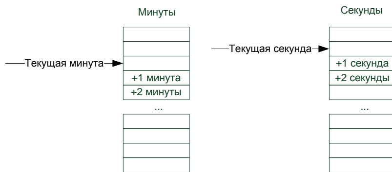
Рис. 70 Структуры данных для иерархического хэширования таймеров
