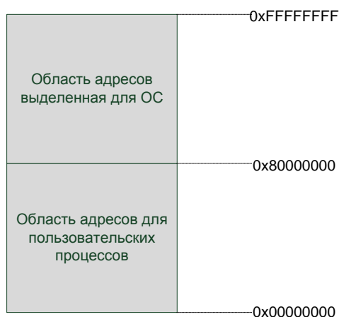
Рис. 41 Распределение адресного пространства
