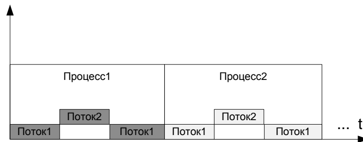
Рис. 22 Циклическое планирование процессов
