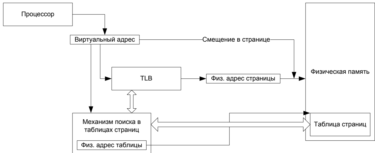
Рис. 17 Механизм работы TLB
