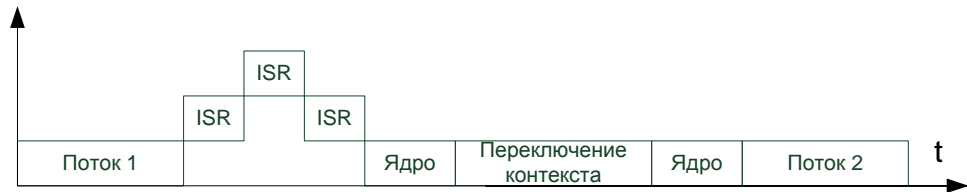
Рис. 32 Переключение контекста после обработки прерываний
