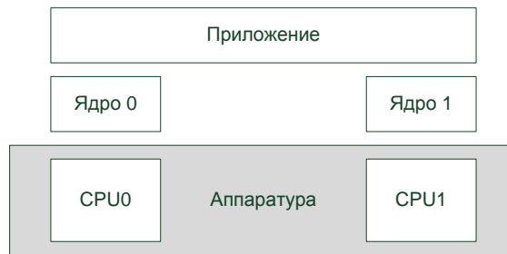
Рис. 59 Использование отдельных экземпляров ОС в многопроцессорной системе
