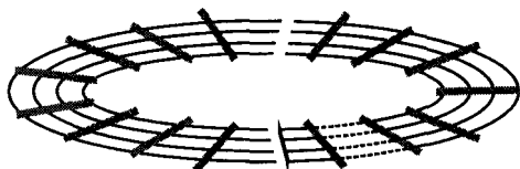
Рис. 8.40. Разбиение жесткого диска на дорожки и секторы
