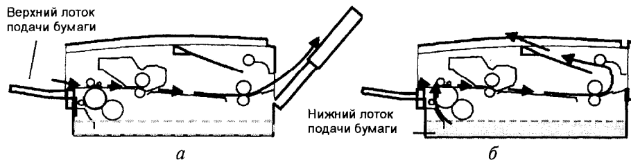
Рис. 6.37. Подача бумаги в лазерном принтере HP LaserJet 5P
