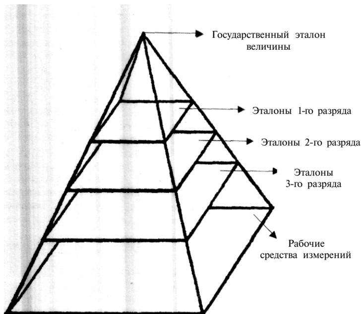
*Рис. 10.* Схематическое изображение системы передачи размера единицы величины
