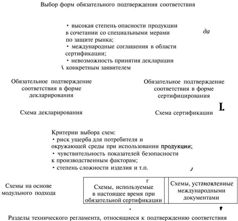
Рис. 19. Блок-схема выбора форм и схем обязательного подтверждения соответствия в технических регламентах
