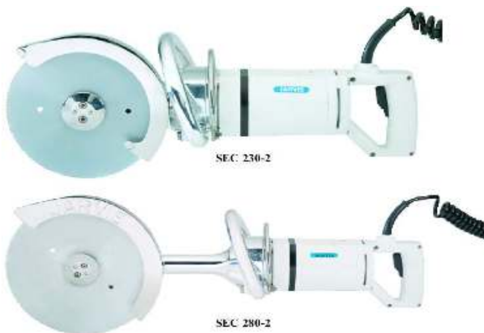
Рис. 2.146. Дисковые пилы для разделки полутуш и четвертин
