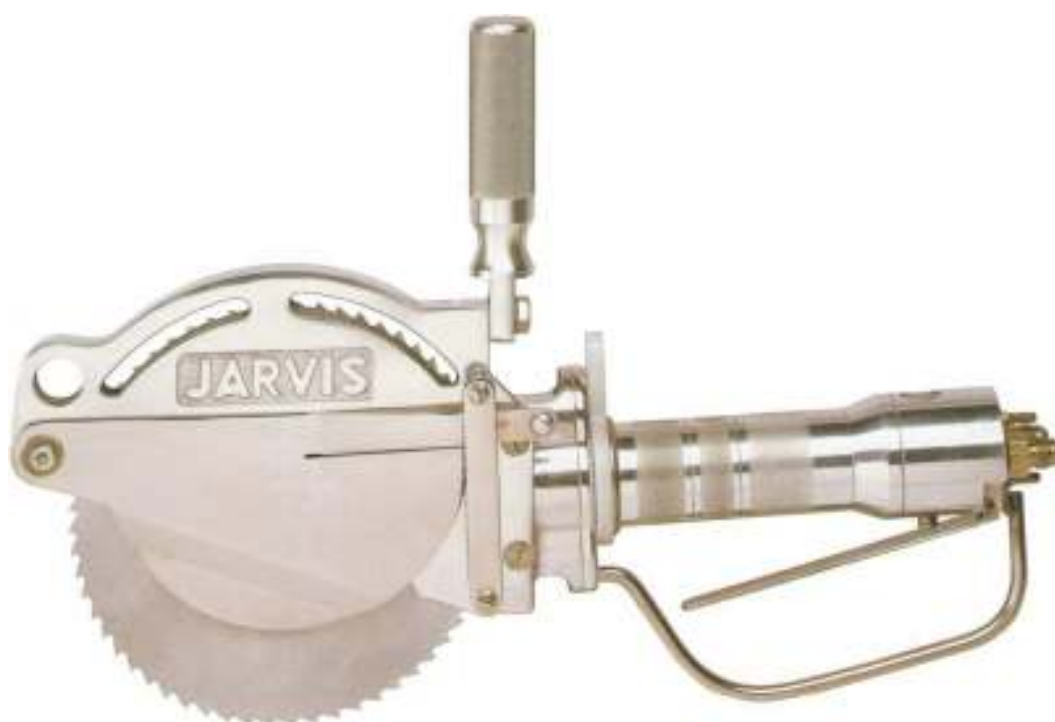
Рис. 2.147 Дисковая пила с гидравлическим приводом для разделки туш
