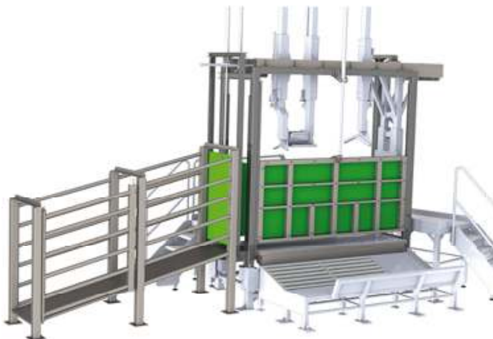
Рис. 2.94 Бокс оглушения КРС и телят мощностью от 100 голов/час
