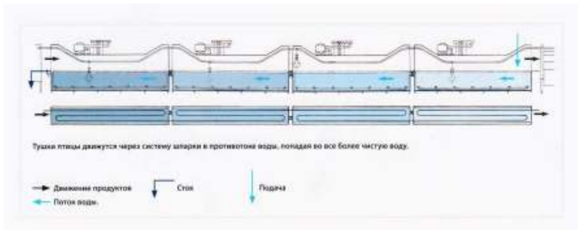
Рис. 2.37 Направления движения продуктов и воды при шпарке в воде
