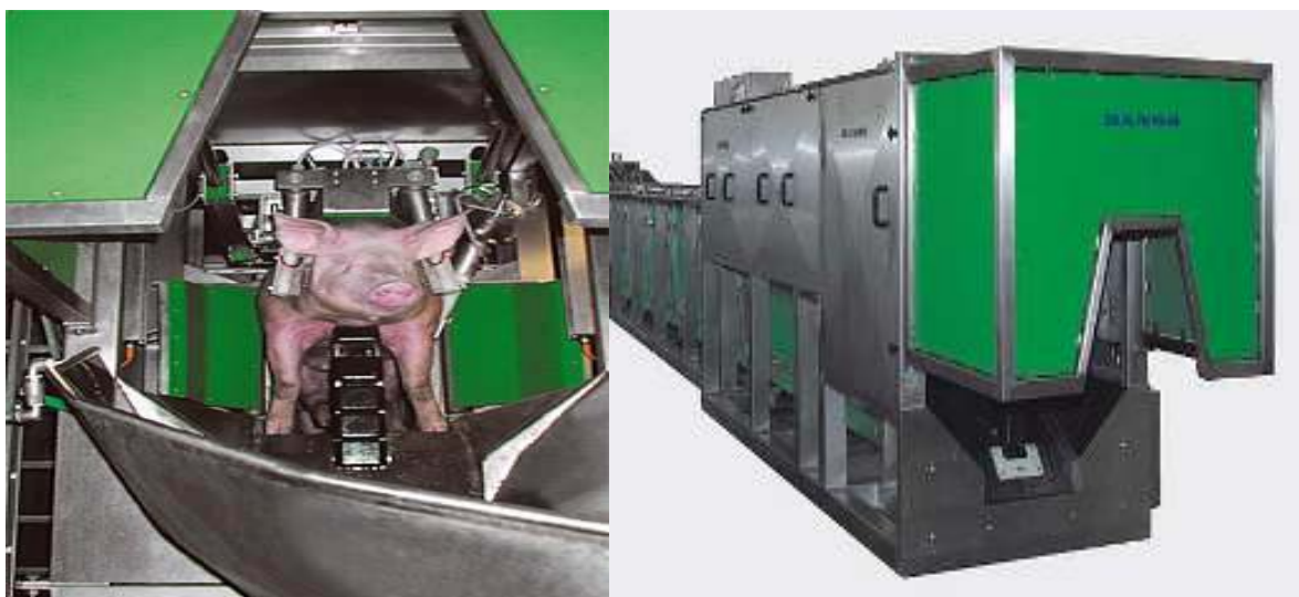
Рис. 2.120. Бокс для оглушения свиней постоянным током высокой частоты
