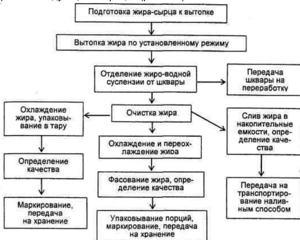
Рис. 2.65 Технологическая схема производства пищевого жира из жира-сырца
