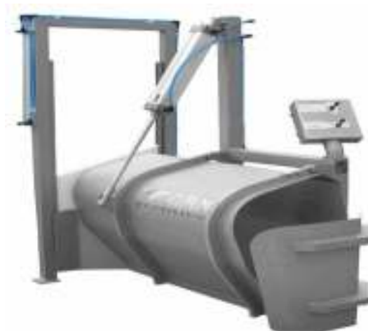
Рис. 2.122. Пневматический бокс для оглушения свиней
