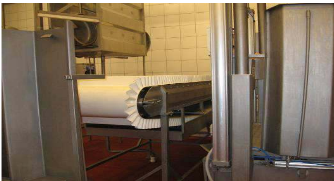
Рис. 2.115. Ленточный конвейер для обработки кишечного сырья
