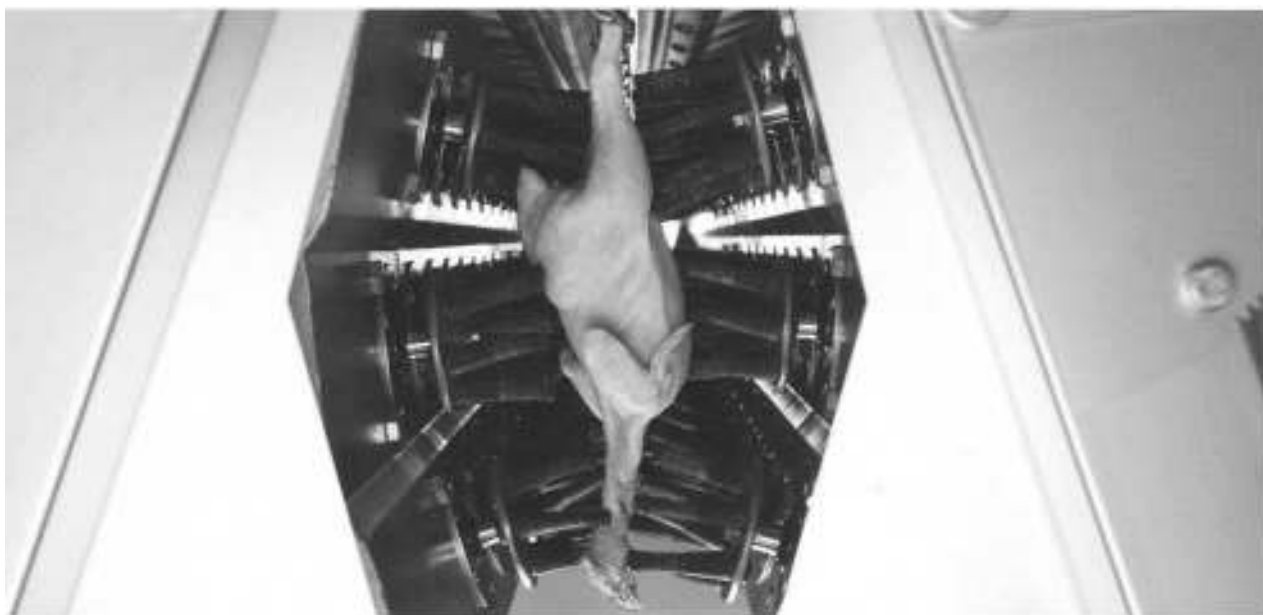
Рис. 2.38 Обработка птицы в аппарате для удаления пера
