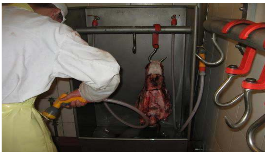
Рис. 2.111 Устройство для мойки голов
