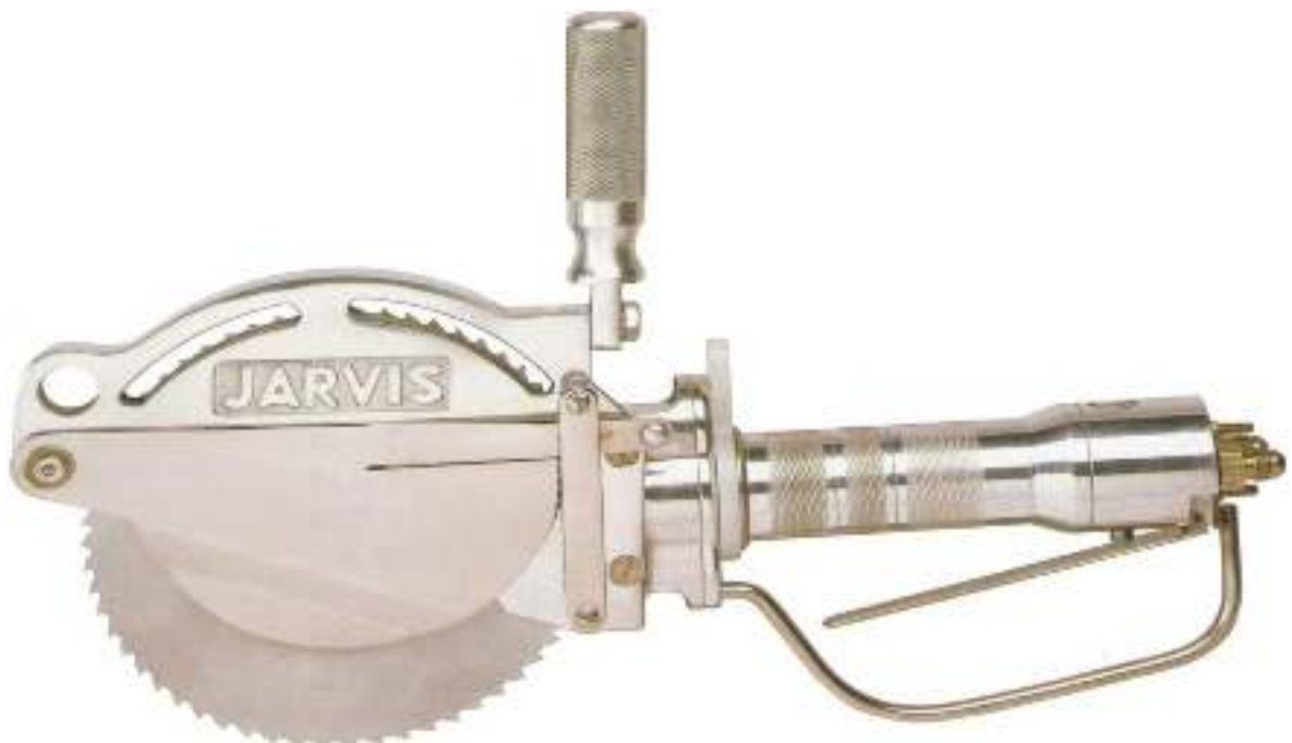
Рис. 2.103. Модель пилы с гидравлическим приводом для деления туш на полутуши
