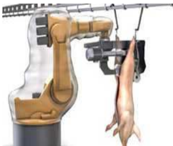
Рис. 2.154 Робот для разуба и распиловки туш на полутуши
