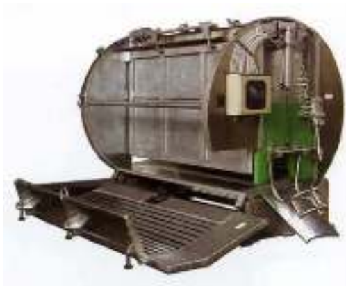
Рис. 2.182. Автоматизировано-механизированная установка поворотного типа
