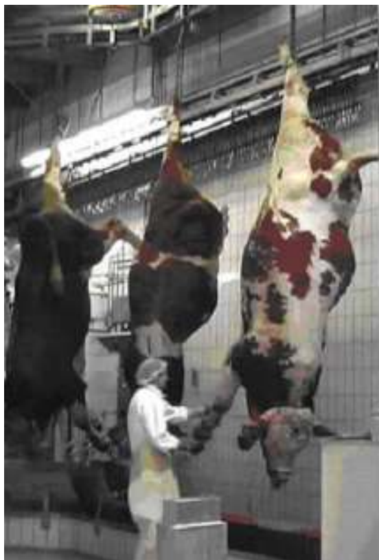
Рис. 2.10. Обескровливание крупного рогатого скота в вертикальном положении
