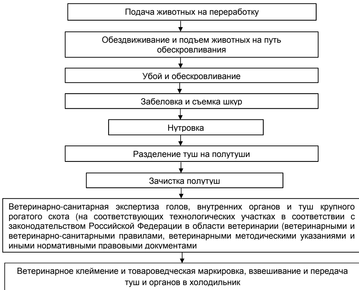
Рис. 2.3. Технологическая схема переработки крупного рогатого скота.
