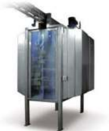
Рис. 2.132. Устройство для мойки свиных туш
