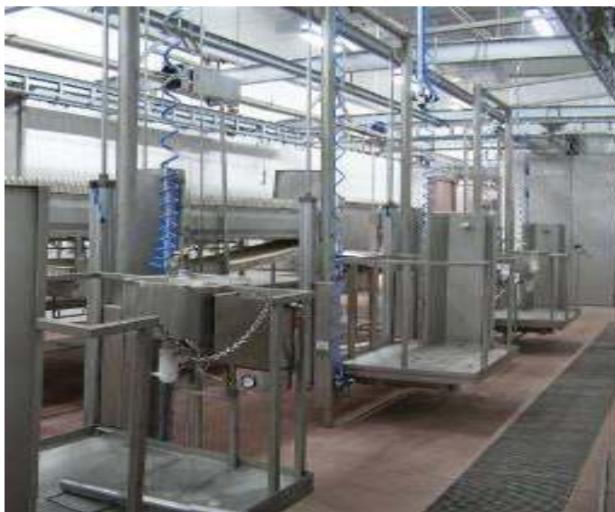
Рис. 2.107 Пневматическая подъемно-опускная площадка
