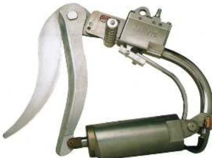
Рис. 2.159. Пневматический секатор для разрезания грудины овец
