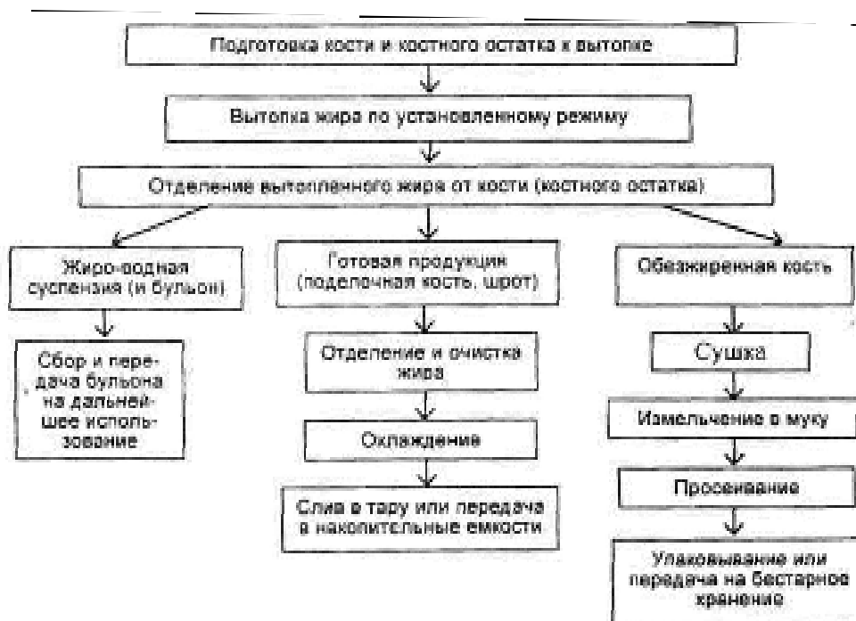
Рис. 2.63 Технологическая схема производства пищевого жира из кости и костного остатка
