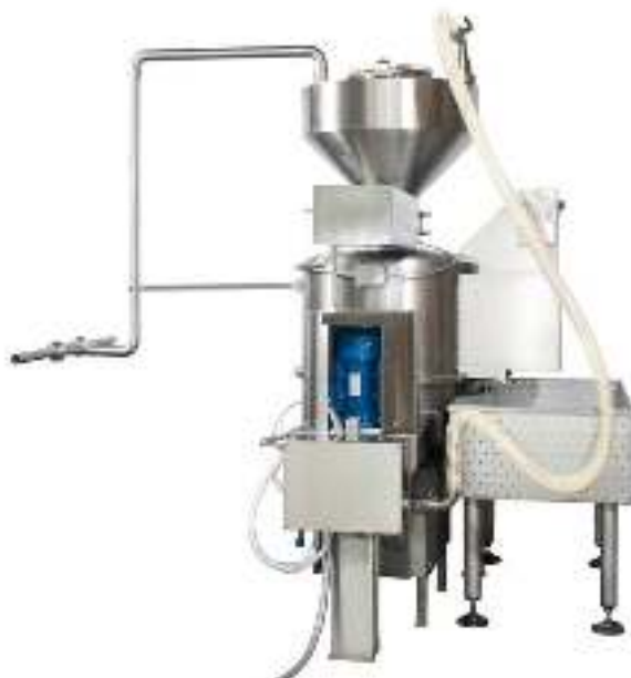
Рис. 2.169. Центрифуга / Инвертор для автоматической промывки прямой кишки свиней и ее выворачивания
