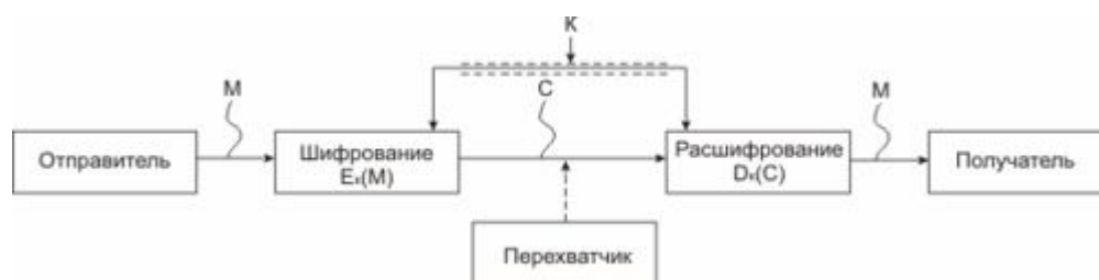
Рис. 10.1 - Обобщенная схема криптосистемы
