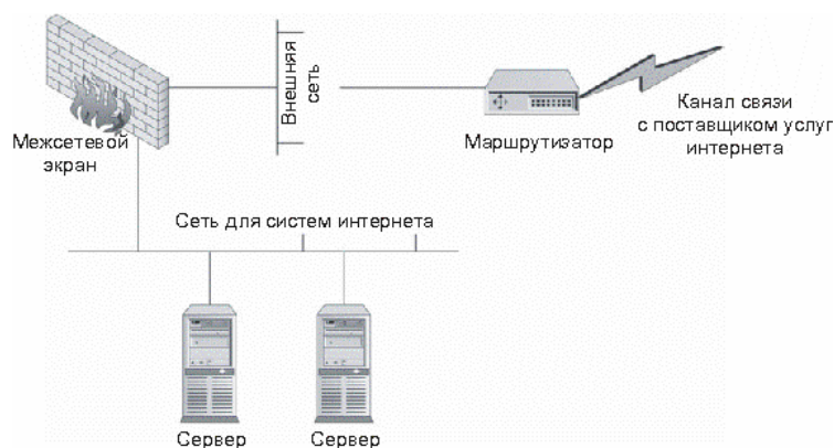
Рис. 17.3 - Использование межсетевого экрана
