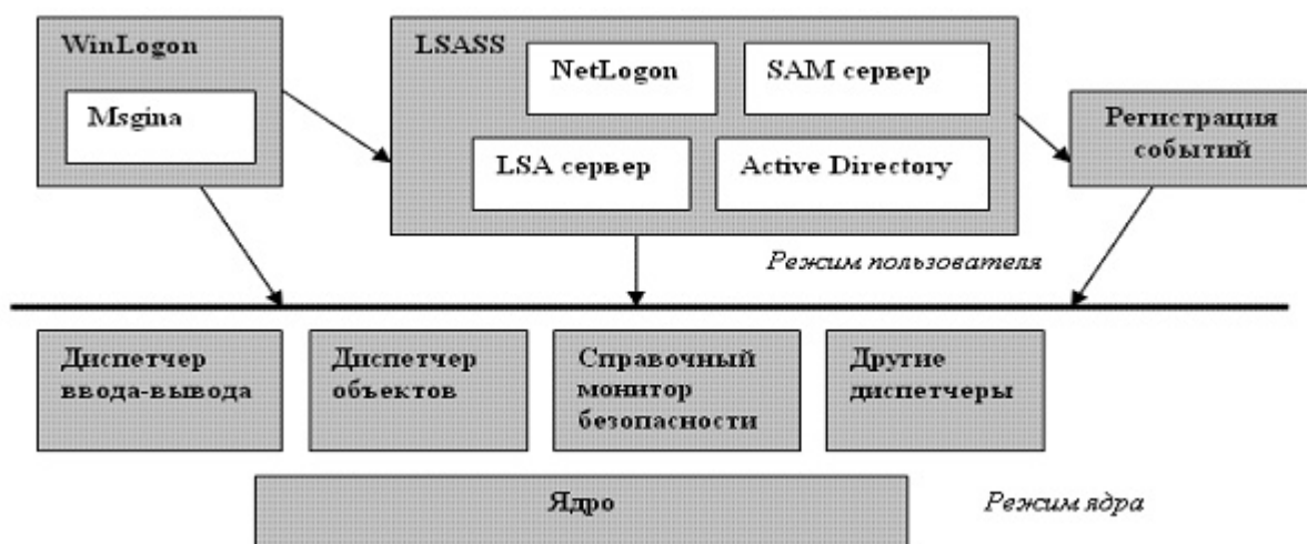
Рис. 19.4 - Структура системы безопасности ОС Windows
