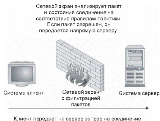
Рис. 17.2 - Передача трафика через межсетевой экран с фильтрацией пакетов
