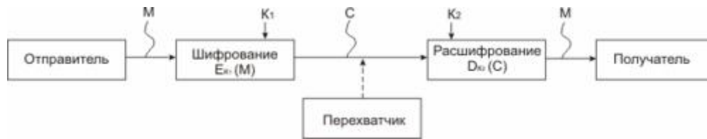
Рис. 10.3 - Обобщенная схема асимметричной криптосистемы с открытым ключом
