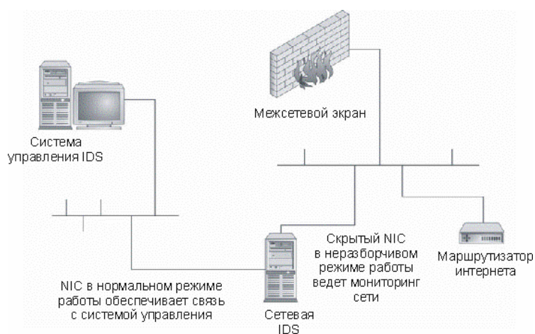
Рис. 17.7 - Конфигурация NIDS с двумя сетевыми картами
