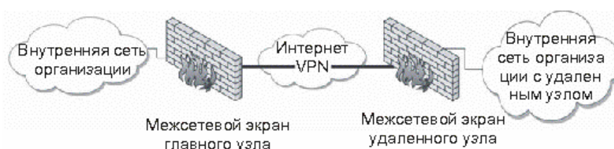
Рис. 17.5 - Межузловое соединение VPN, проходящее через интернет
