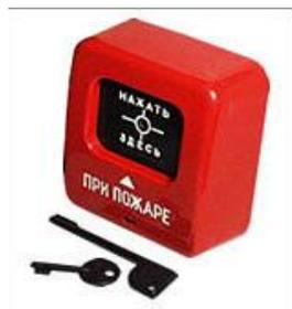
**Извещатель пожарный ручной ИПР 513-2 "АГАТ"** предназначен для подачи сигнала тревоги на средства пожарной и охранно-пожарной сигнализации при воздействии на него человека. Применяется в составе АСОЗ совместно с ПКП или УСП, обеспечивающими в шлейфе пожарной сигнализации напряжение 9-30 В
