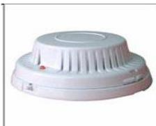
**Извещатель пожарный дымовой оптико-электронный ИП 212-39/1 "АГАТ"** предназначен для обнаружения загораний, сопровождающихся появлением дыма в закрытых помещениях. Применяется в составе автоматизированных систем обнаружения загораний (АСОЗ) совместно с приёмно-контрольными приборами (ПКП) или устройствами сигнально-пусковыми (УСП), обеспечивающими в шлейфе пожарной сигнализации напряжение 7-30 В. Имеет встроенную сирену и при срабатывании выдает громкий, 85 дБ, прерывистый звуковой сигнал.
