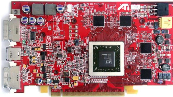
Рисунок 27. Вид видеоадаптера (ATI RADEON X850 XT PE)
