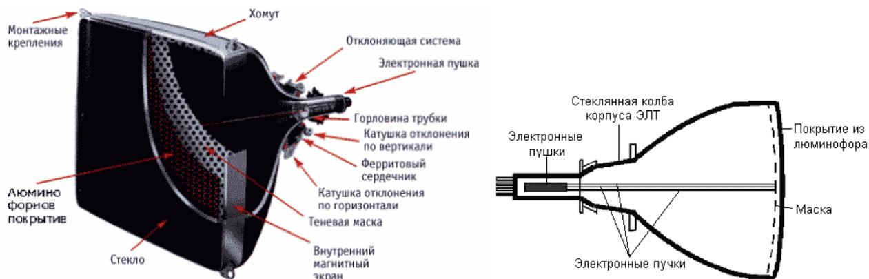
Рисунок 25. Монитор с электронно-лучевой трубкой
