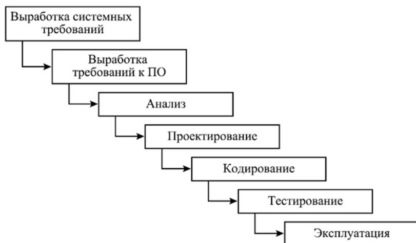
Рисунок 13 – Каскадная модель жизненного цикла программного обеспечения (водопад)
