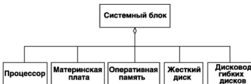
Рисунок 20 – Диаграмма классов для иллюстрации отношения агрегации на примере системного блока ПК
