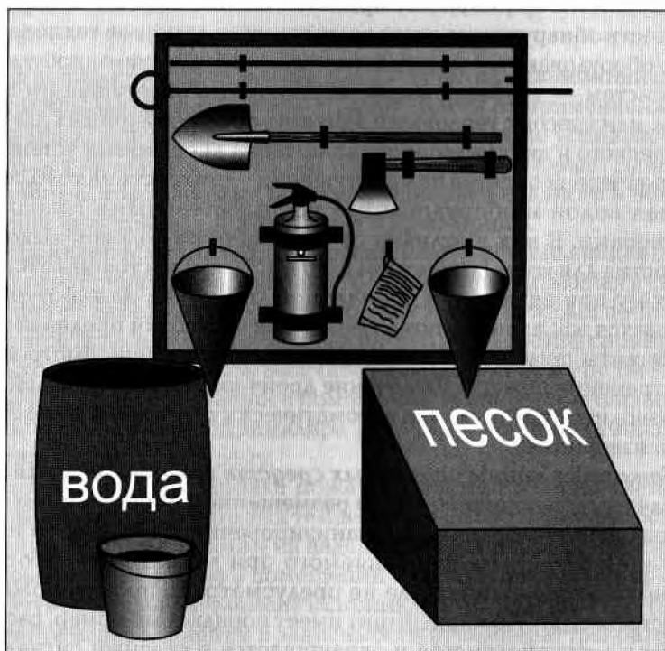
Рис. 5.1. Пожарный щит первичных средств пожаротушения
