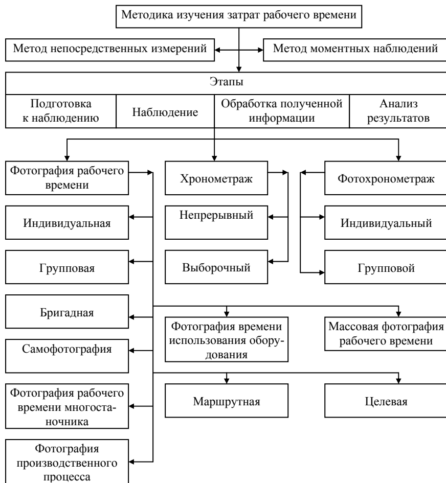
Рис. 11.2. Классификационная схема методов изучения затрат рабочего времени 1
