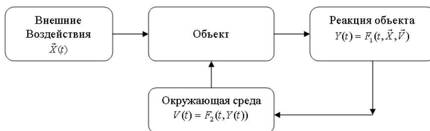
Рис. 4.1. Структура модели элемента типа «черный ящик».
