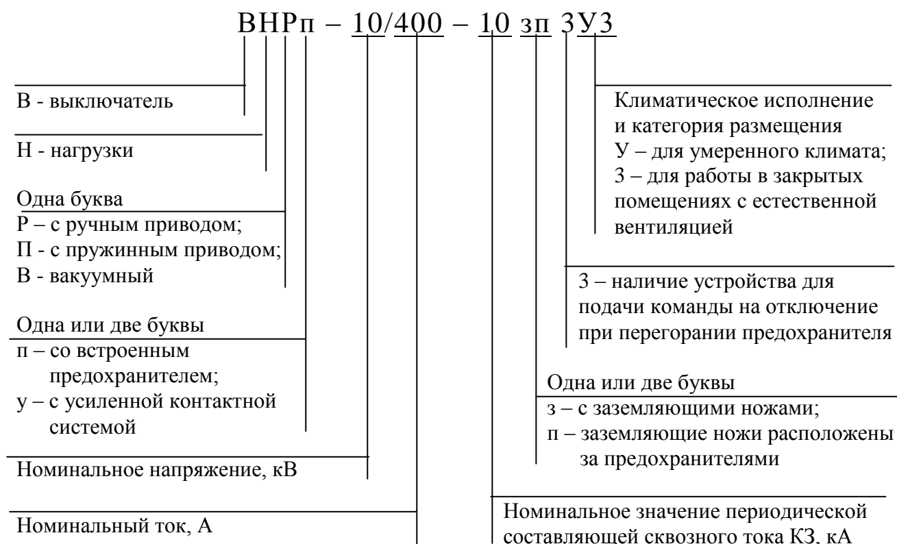
Рис.5.3. Структура условного обозначения выключателей нагрузки
