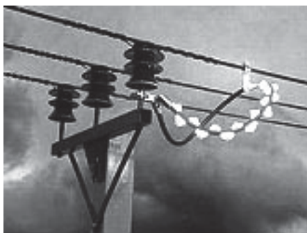
Рис. 4.6. Момент срабатывания усовершенствованного разрядника РДИП1
