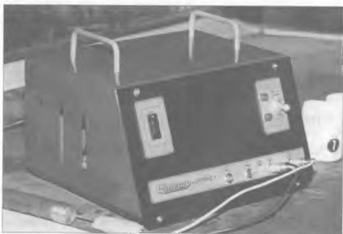
Рис. 3.1. Источник питания гальванической установки «Цинкор-сервис»
