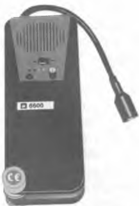
рис. 3.6. Мобильный ультразвуковой детектор для определения герметичности швов вклеенного стекла
