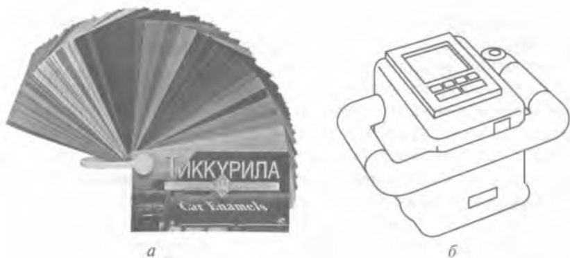
Рис. 4.4. Набор ручных тест-пластин (а) и светофотометр (б)
