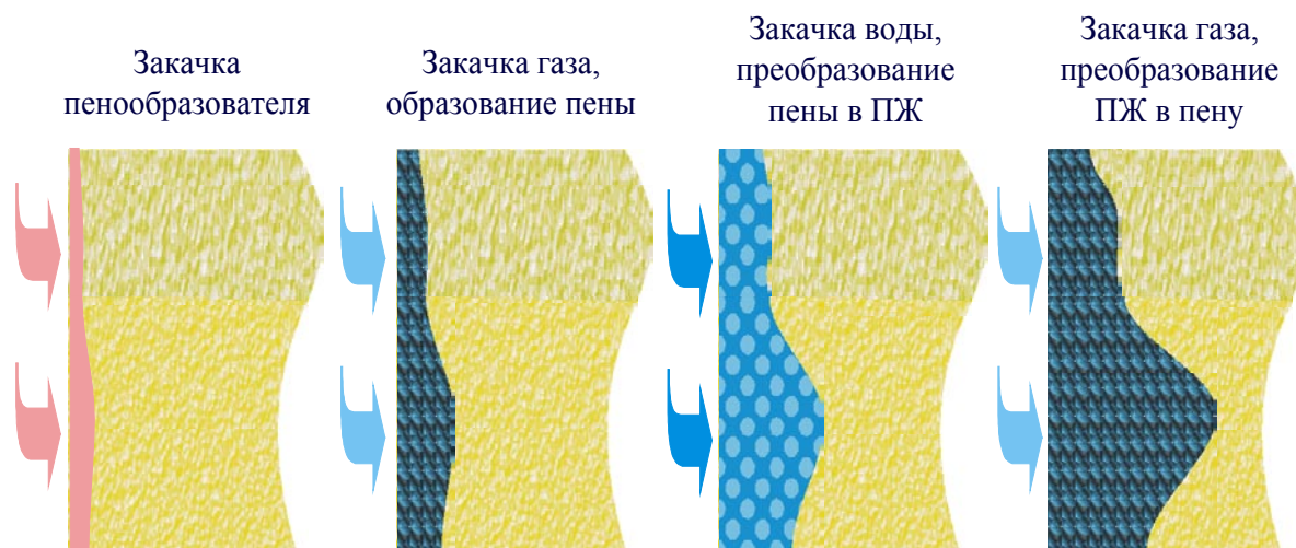
Рис. 6.16. Схема циклического закачивания пены.
