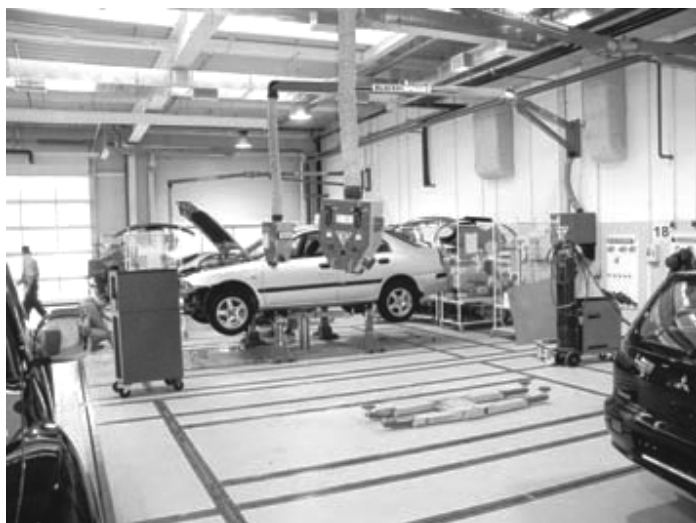
Рис. 3.41. Схема установки и закрепления кузова легкового автомобиля на стенде Р-620 (вверху) и современный напольный стенд «Korek» (снизу)
