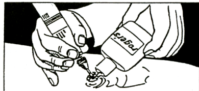
Рис. 3.107. Обработка восстанавливаемого места финишной смолой, шпатель и полирование
