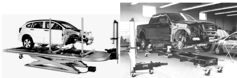
Рис. 3.61. Стапель Chief Fuzion (слева) и входящий в его состав стапель Shop-Hopper (справа) с захватами для закрепления кузова автомобиля
