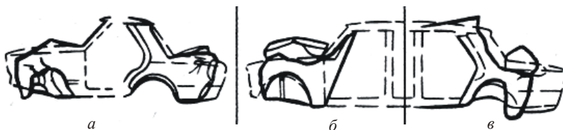
Рис. 3.9. Переко́с кузова повышенной сложности: а – передних и задних лонжеронов; б – передних лонжеронов и каркаса салона; в – задних лонжеронов и каркаса кузова
