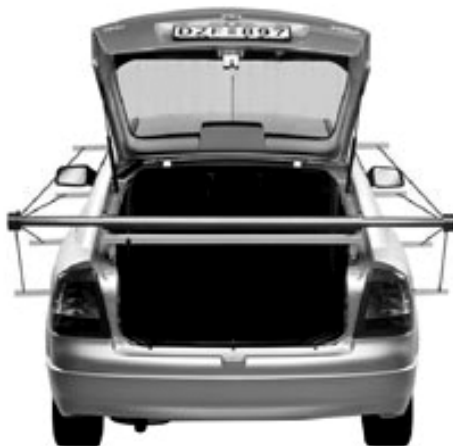
Рис. 3.59. Схема применения системы Upperbody Laser, позволяющей определять координаты любых точек поверхности кузова, в том числе и точек верха кузова
