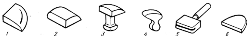
Рис. 3.15. Фасонные плиты, оправки, наковальни: 1 – плита для чистовой отделки поверхности лицевых деталей; 2 – плита для исправления вмятин; 3, 4 – наковальни для восстановления профилей деталей; 5 – оправка для исправления фланцев и желобов; 6 – плита для отделки плоских поверхностей
