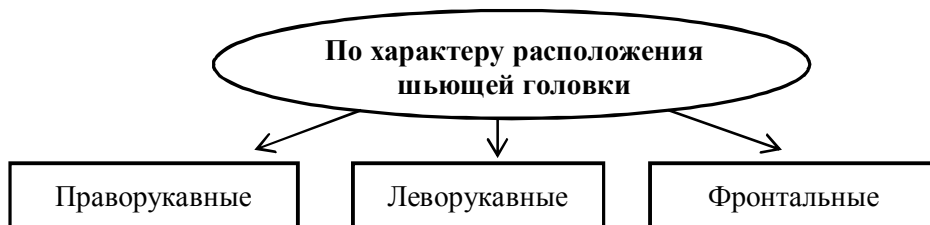
Рис. 6. Классификация швейных машин по характеру расположения шьющей головки
