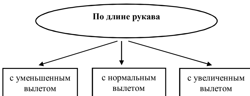
Рис. 8. Классификация швейных машин по длине рукава
