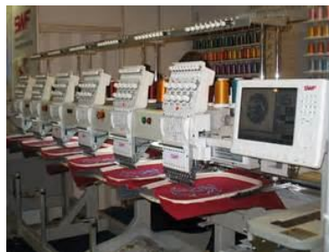
Рис. 21. Вышивальный полу автомат с компьютерным управлением
