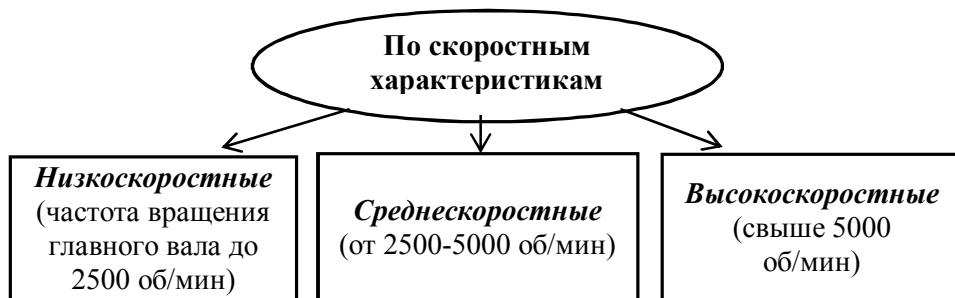
Рис. 5. Классификация швейных машин по скоростным характеристикам
