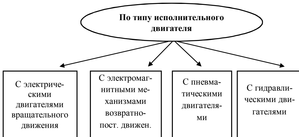
Рис. 10. Классификация швейных машин по типу исполнительного двигателя
