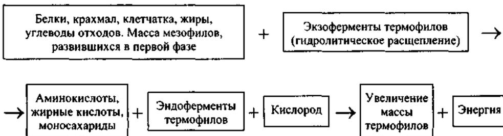
Следовательно, под действием экзоферментов термофилов разрушаются сложные органические молекулы отходов и отмерших мезофилов до простых веществ. Аминокислоты, жирные кислоты, моносахариды термофилы используют как пластический и энергетический материал, что обуславливает увеличение их массы.
