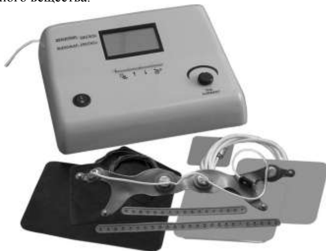
Рисунок 3 - Универсальный аппарат "ЭЛЭСКУЛАП", предназначен для гальванизации и проведения лекарственного электрофореза.
