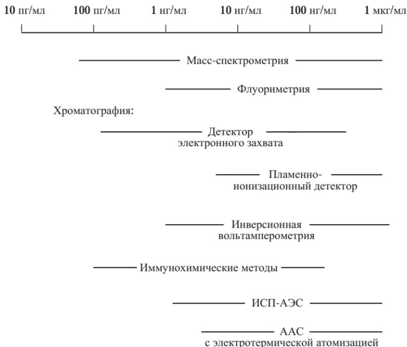
Рис. 7.1. Диапазоны концентраций СОЗ, определяемых различными методами
