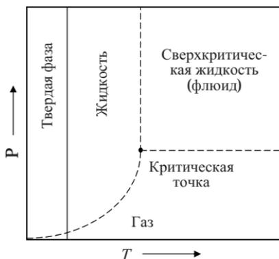
Рис. 6.5. Диаграмма состояния растворителя в зависимости от температуры и давления
