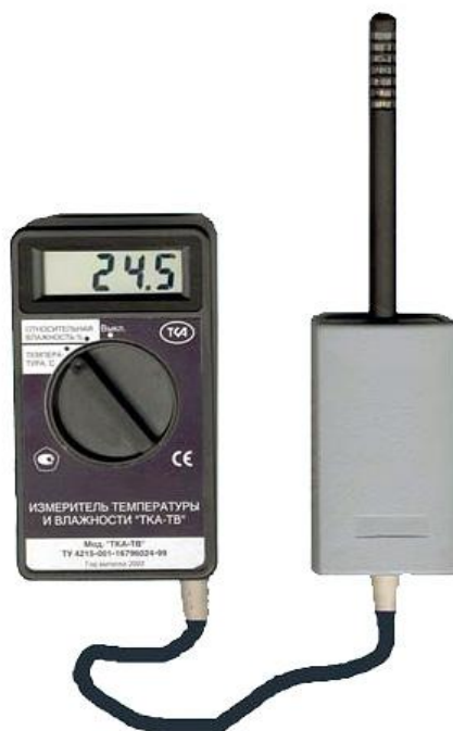
Рисунок 5 – Прибор для измерения температуры и относительной влажности воздуха («ТКА–ПКМ, модель 20»)
